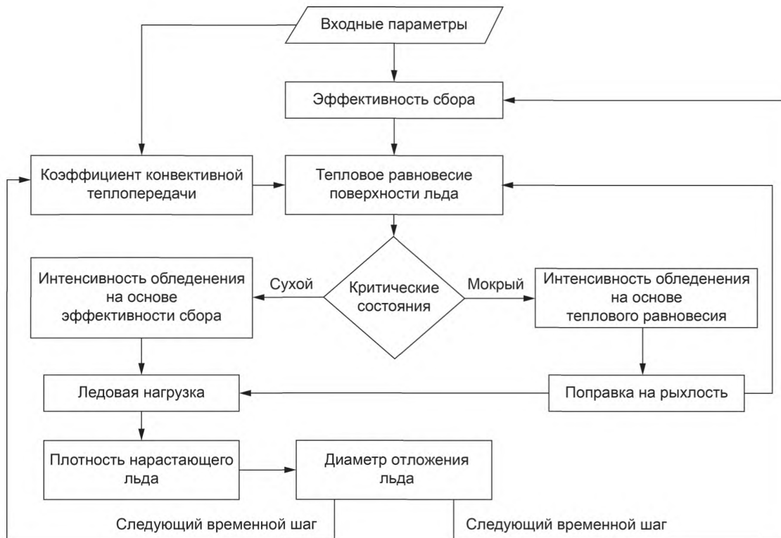
Рисунок С.5 — Упрощенная блок-схема численной модели обледенения
